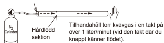
Lödning av röret under sköljning av kvävgas
