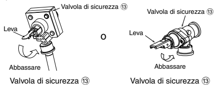
Valvola di sicurezza ⑬
