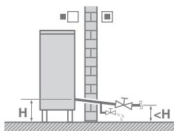
Når der er uvirkligt vand i systemet, er det meget sandsynligt, at det fryser til, hvilket kan skade systemet.
